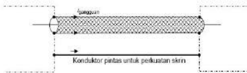
Gambar 44.R1 Konduktor pintas untuk perkuatan skrin untuk memberikan sistem ikatan ekuipotensial bersama
