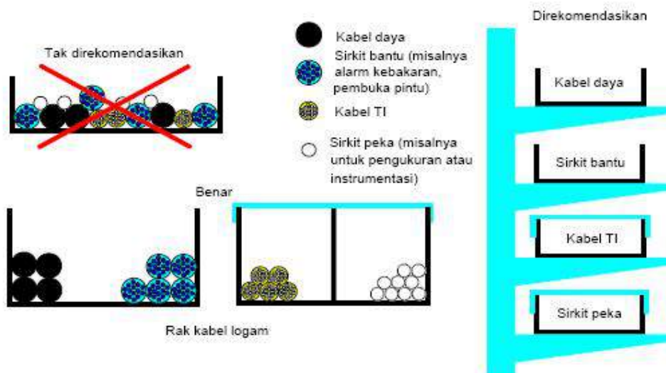
Gambar 44.R18 Pemisahan kabel pada sistem perkawatan
