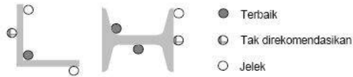
Gambar 44.R21 Lokasi kabel di dalam elemen konstruksi logam
